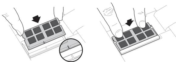
Poussez fermement le module SODIMM à un angle de 45 degrés, puis appuyez dessus jusqu'à ce que les clips s'emboîtent et que le module reste bien en place. Une fois le module correctement installé dans l'emplacement, les broches dorées dépassent d'environ 1,5 mm.
