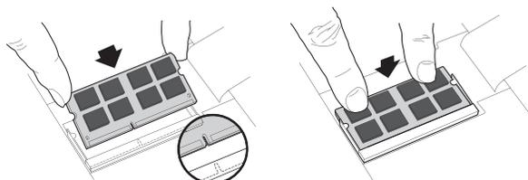
Inserire il modulo SODIMM tenendolo inclinato di 45°, quindi premi su di esso finché le levette non scattano in posizione. Dopo averlo posizionato nello slot, saranno visibili 1,5 mm o una porzione inferiore dei pin oro.
