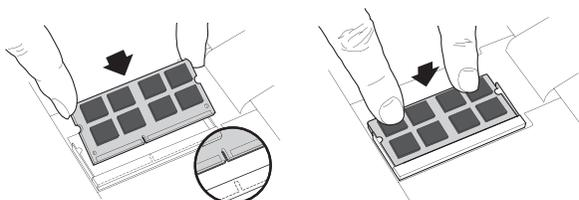
45度の角度を付けてSODIMMをしっかり押し込み、クリップが所定の位置にカチッとハマるまで押し下げます。スロットにきちんとハマると、金のピン部分が見える長さが1.5mm以下に収まります。
