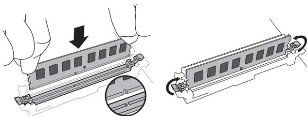
安定した均一な力で、クリップがカチッとハマるまでDIMMをソケットに押し込みます。クリップを無理にはめ込まないでください。
