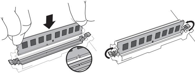
使用穩定、均勻的施壓，將 DIMM 推入插槽，直到扣件完全卡緊為止。不要推扣件。
