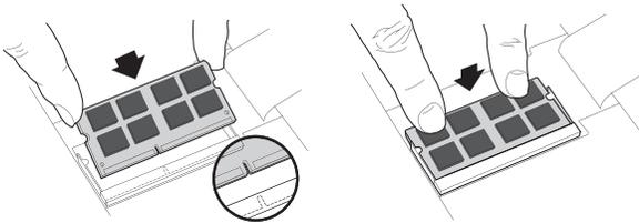
以 45 度角用力推進 SODIMM，然後向下按壓，直到接頭牢固地插入插槽中為止。當它完全固定在插槽中時，可以看見的金色針腳長度在 1.5mm 以下。
