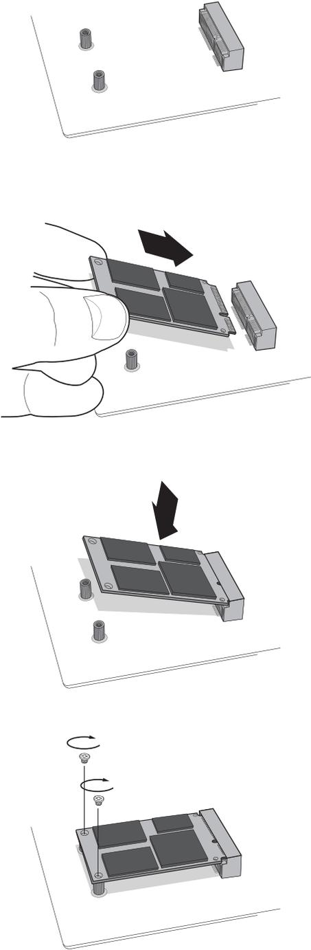
图 2: 采用夹子的固态硬盘的安装
