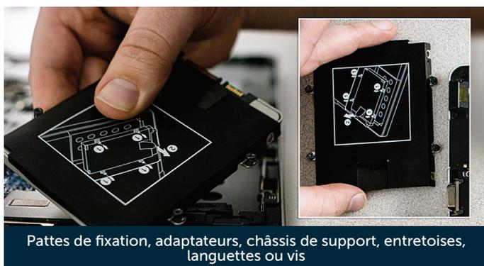
Pattes de fixation, adaptateurs, châssis de support, entretoises, languettes ou vis
